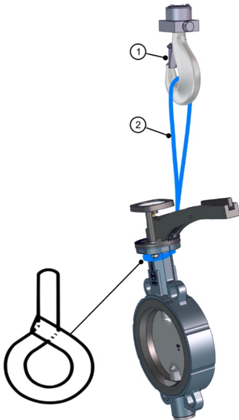
รูปที่ 6: การยกวาล์วปีกผีเสื้อแบบเวเฟอร์
