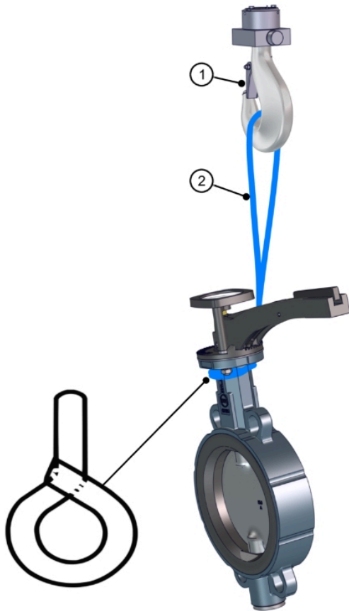
Obr. 6: Preprava medziprírubovej klapky žeriavom
