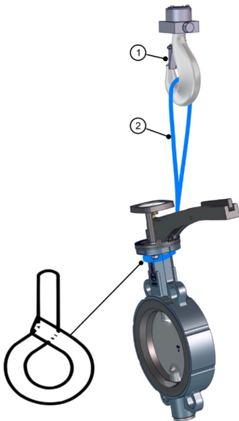
Fig. 6: Bruk kran på mellomflensspjeldet
