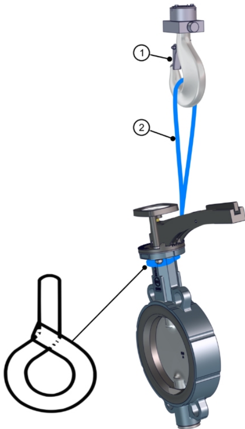
Fig. 6: Trasporto valvola a farfalla a flangia intermedia con gru
