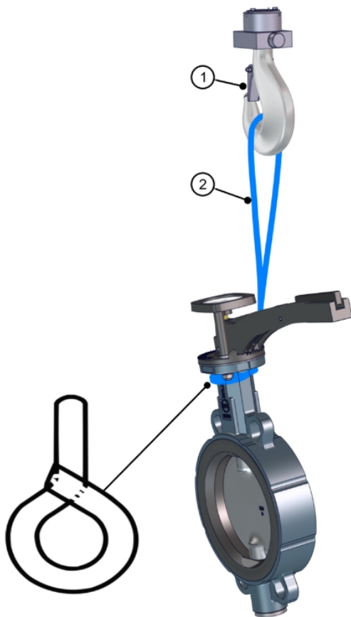
图 6: 起吊中间法兰罩
