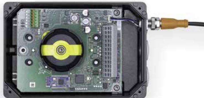
**ÜBER INTEGRIERTE SENSOREN** erfasst EBRO SBU IO-Link die wichtigsten Parameter der Armatur. Dazu zählt für die Überwachung der Endlage ein zuverlässiger Hall-Sensor.
