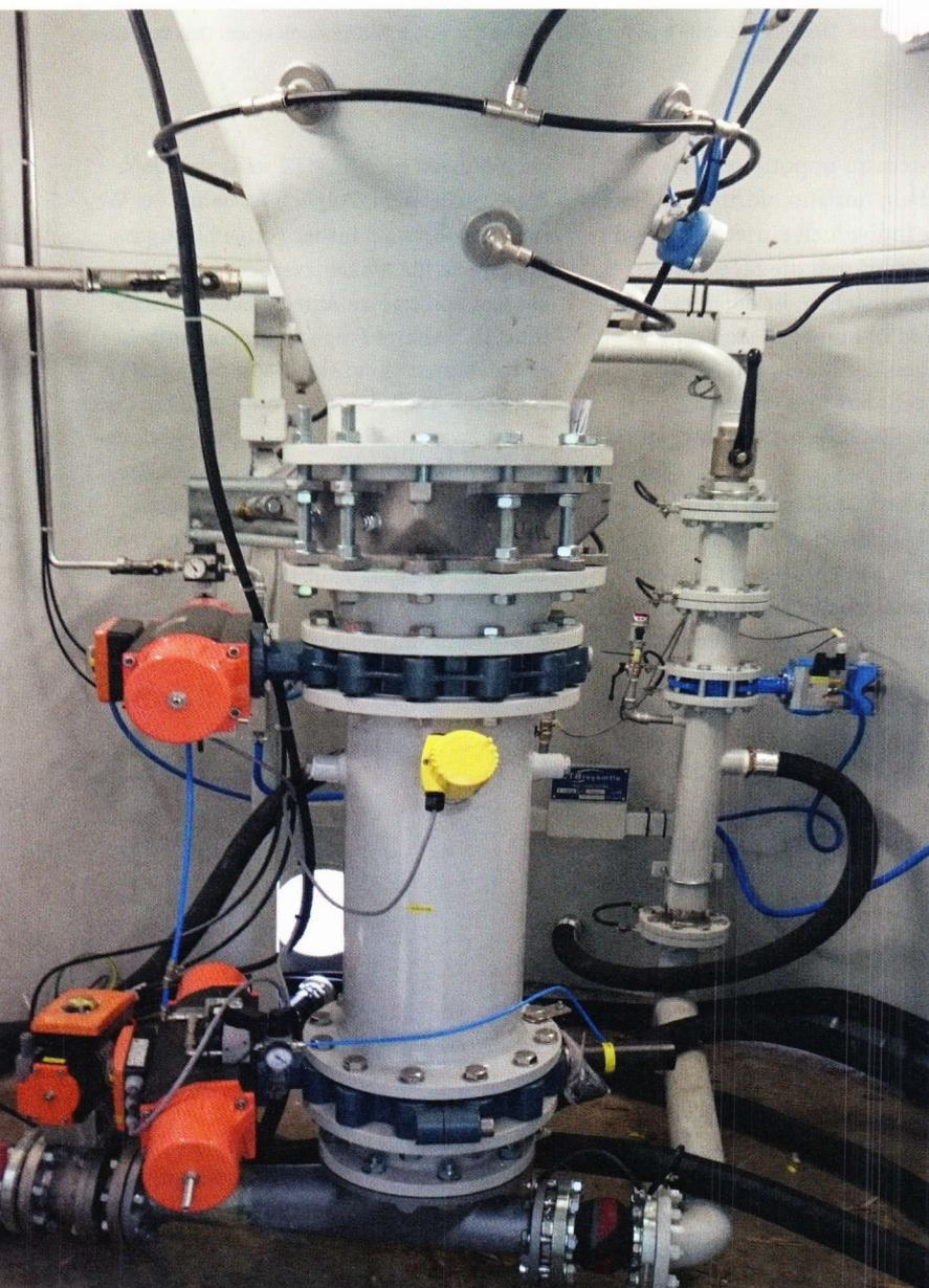
Bild 1: Ex-entkoppelnde Taktschleuse dosiert Pulver in die Förderleitung.
