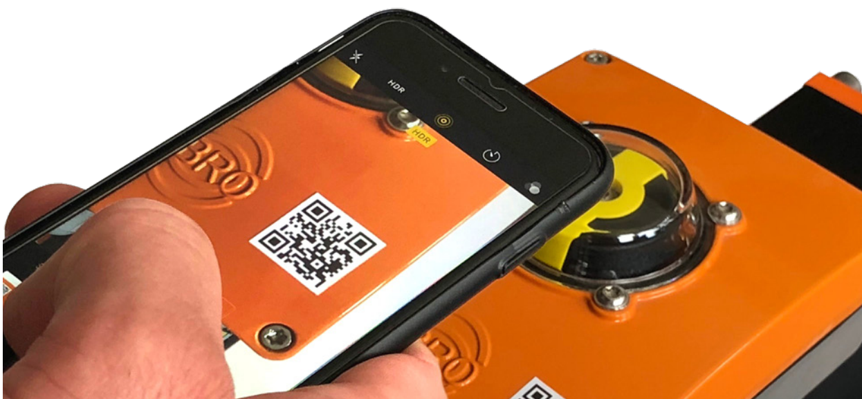
Bild 2: Die App identifiziert die Baugruppe per Bluetooth oder QR-Code. Spezifikation und Auswertungen können im Klartext ausgelesen und direkt in die Cloud des Anwenders übertragen werden.
