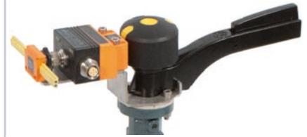
Bei handbetätigten Armaturen erfolgt die AS-i Busankopplung über einen Doppelsensor mit Flachkabelanschluß und 2 induktiven Positionssensoren. Die Endlagenrückmeldung erfolgt mittels Drehpuck.
