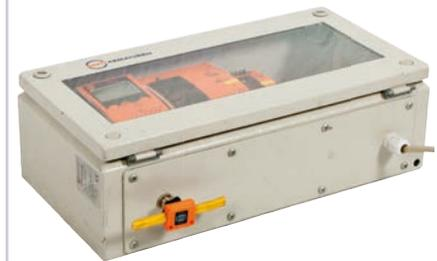
Die AT-Mastersysteme stellen das Gateway zu den höheren Bussystemen wie Profibus oder Ethernet her. Sie beinhalten als Black Box alle benötigten Komponenten für den Betrieb von einem oder zwei AS-i Netzwerken. Der Master steuert den Datenaustausch zur Sensor-/ Aktuator-Ebene und der Controller verarbeitet, wenn erforderlich, die Peripheriedaten als „stand alone“ Steuerung im integrierten Prozessor (Signalvorverarbeitung)
