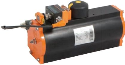
Für alle pneumatischen Schwenkantriebe hat EBRO eine AS-i Busankopplung. Ein 24V Magnetventil mit geringer Leistung wird über das gelbe zweiadrige Kabel gesteuert. Über einen Drehpuck werden die Endlagenstellungen der Armatur an den AS-i Doppelsensor AT2316 signalisiert. Diese kommuniziert mit dem AS-i Bus.
