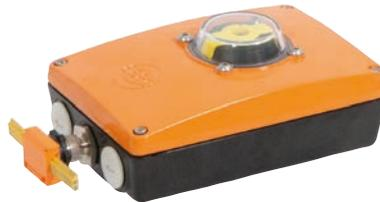
Auch unser SBU Schaltkasten ist für den Anschluss an ein AS-i Bus lieferbar. Die Armaturenlagerückmeldung erfolgt über zwei Mikroschalter oder induktive Sensoren. Ein 24V Magnetventil mit geringer Leistung, sowie die Rückmeldungen werden mittels Interface über das AS-i Kabel gesteuert und signalisiert.
