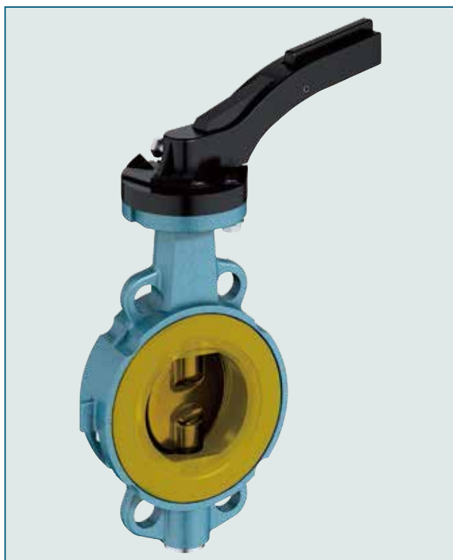
对夹式蝶阀，特殊材质的包覆阀板和阀座，专为磨损性工况设计。
