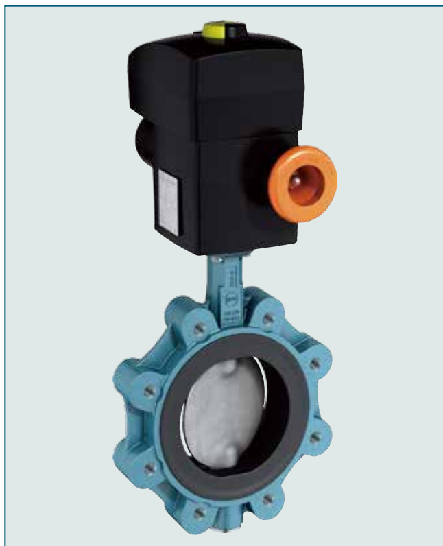
支耳式蝶阀法兰孔为螺纹孔，可作为终端阀。
