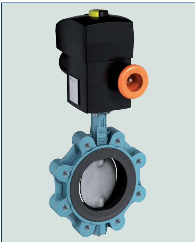
Přírubová klapka, se závitovými otvory. Toto provedení umožňuje na jedné straně odpojit potrubí z příruby.
