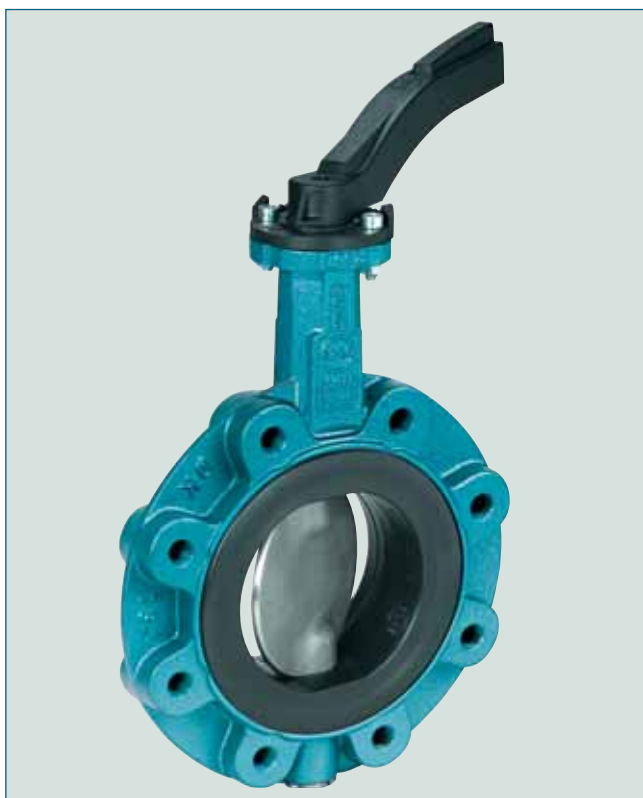
Valvola a farfalla LUG con fori filettati. Questa versione permette l'utilizzo a fine condotta (sempre con impiego di controflangia).
