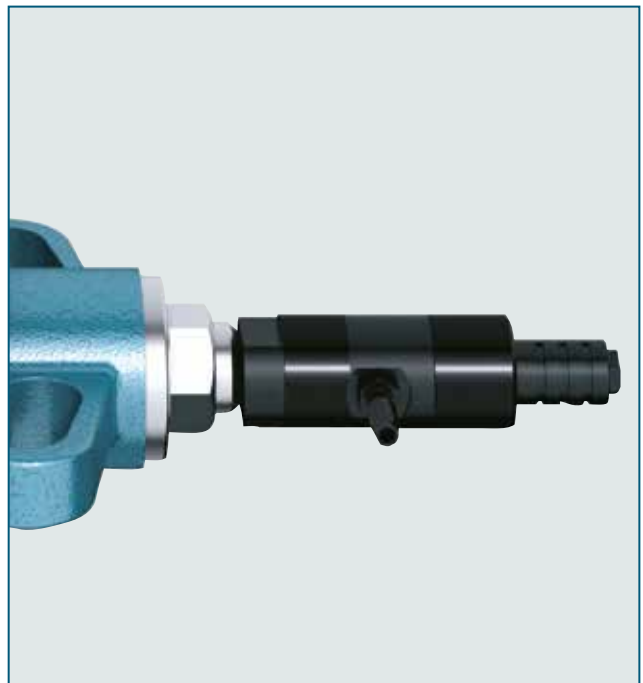
通过阀门底部的振动发生器，带动阀板做轴向振动。振动的频率可以通过气压控制。
