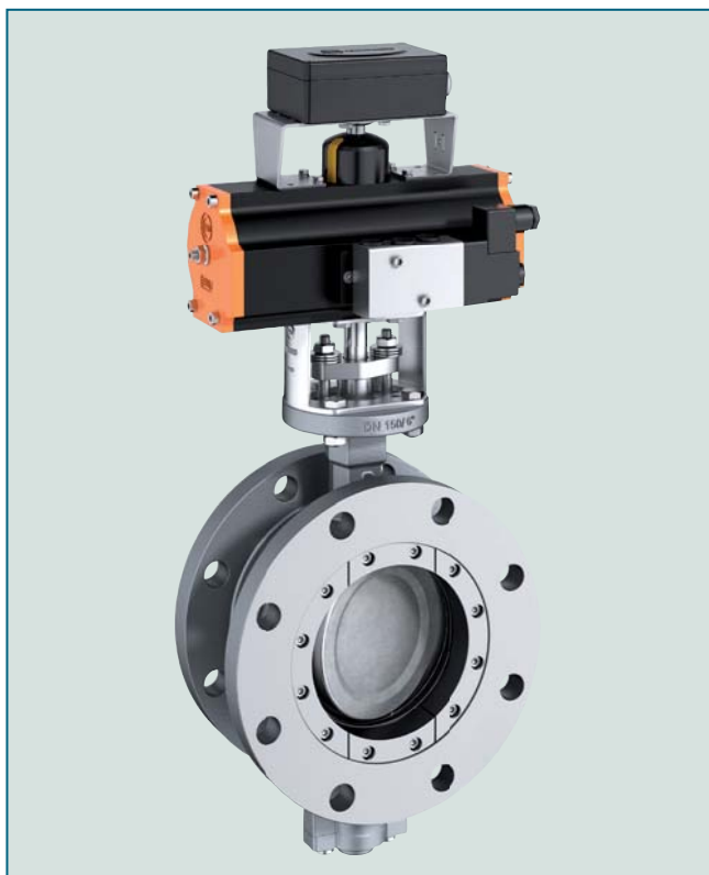
Uzavírací a regulační klapka typ HP 112 s dvojitou přírubou a diskem klapky s dvojitým excentrickým uložením.
