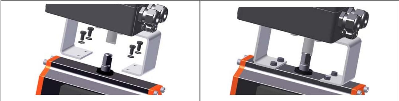
Bild 15: Schwenkantriebbefestigung
