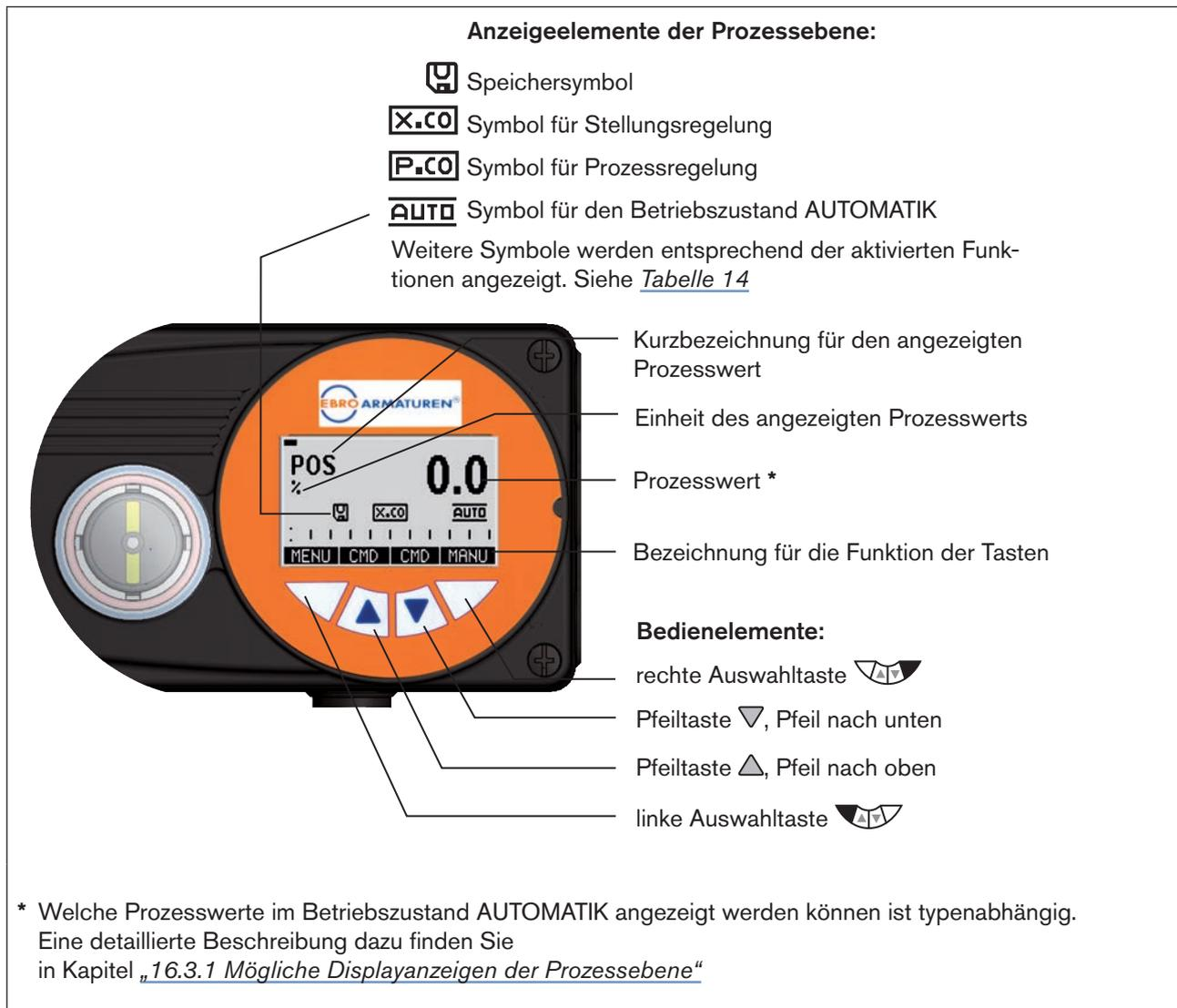
Bild 19: Anzeige und Bedienelemente der Prozessebene
