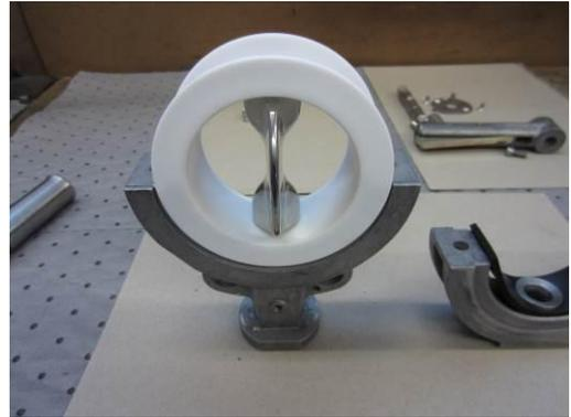
10. Manschette und Scheibe in die obere Gehäusehälfte einsetzen
