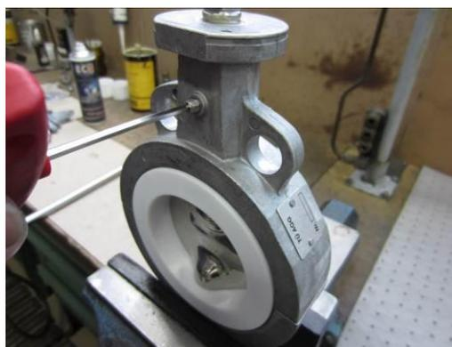
17. Gewindestift (Sicherungsschraube) bis zum Wellenkontakt einschrauben.
