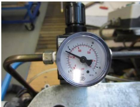
21. Prüfdruck max.4bar
