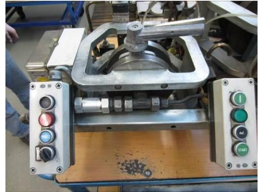
20. Fertige Armatur auf Dichtheit prüfen. Gemäß Angabe PS auf dem Typenschild, maximal 4bar, Prüfgrundlage EN12266-1
