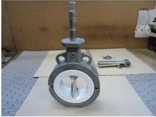
13. O-Ring Bereiche der Welle einfetten und die das Gehäuse einführen.
