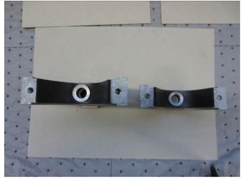
8. Elastomereinlage und Druckstücke einlegen
