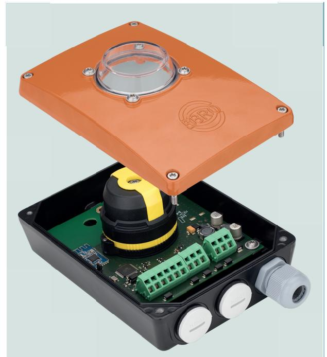
Ein Mikrocontroller überwacht die Armaturenstellung berührungslos mit Hilfe eines Hall-Sensors. Zusätzlich werden das Fahrverhalten und die Funktion von Armatur, Antrieb und Magnetventil kontinuierlich überprüft.
