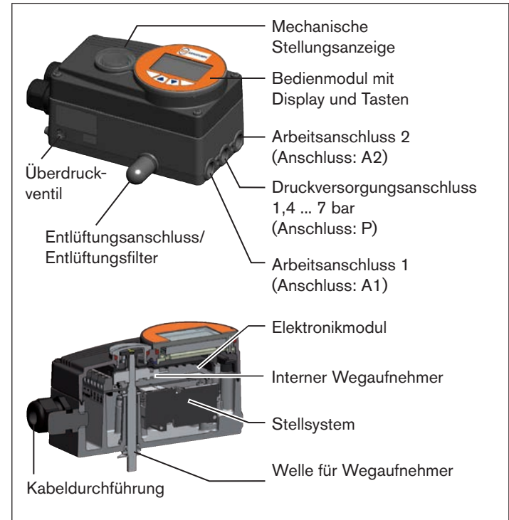
Bild 1: Aufbau Typ EP 501/EP 501 C
